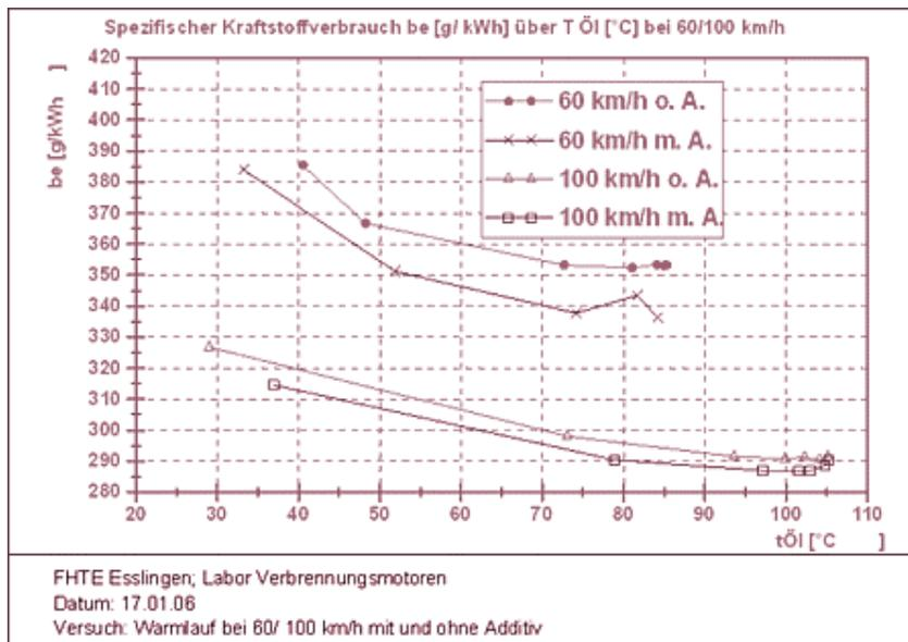
Es ist unvermeidbar, dass der Motor auch bei dem angestrebten Konstantbetrieb auf dem Prüfstand infolge der verschiedenen Regelvorgänge (Prüfstandsregelung, Lambda-Regelung, Kühlwasserthermostat usw.) leichte Schwankungen im Drehmoment aufweist, die ein starres Einhalten der Last unmöglich machen. Daher ist es sinnvoll, nicht die absoluten Verbräuche (wie in Bild 1 geschehen), sondern die auf die Leistung bezogenen Verbräuche (sog. effektiver spezifischer Kraftstoffverbrauch be) zu vergleichen.
